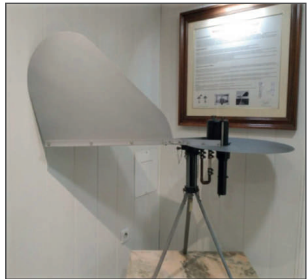
Captador tipo HIRST utilizado por el Dr. E. Subiza, colocado en una de las salas de la Clínica del Dr. Javier Subiza
